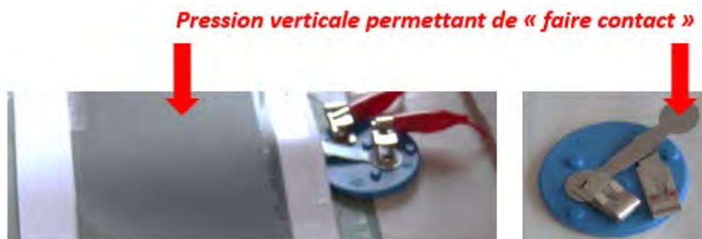
Figure 58 : Photo commentée de la solution retenue pour actionner l'éclairage des maquettes
